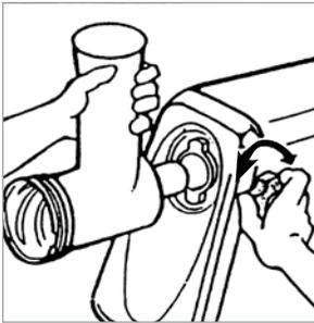
3. Lösen Sie die Klemmschraube rechts am Motorgehäuse einige Umdrehungen gegen den Uhrzeigersinn bis sich das Schneckengehäuse ohne Widerstand aus dem Motorgehäuse herausziehen lässt.
