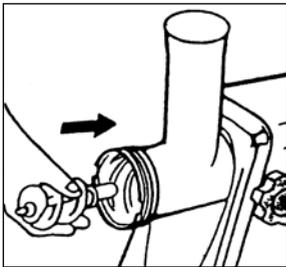
2. Stecken Sie die Schnecke mit dem längeren, schmalen Ende in die Auslassöffnung des Schneckengehäuses. Drehen Sie die Schnecke dabei eventuell etwas. Die Schnecke muss ganz im Inneren des Gehäuses liegen. Nur der dünne Metallstift in der Mitte der Schnecke ragt ca. 9 mm aus dem Schneckengehäuse heraus.
