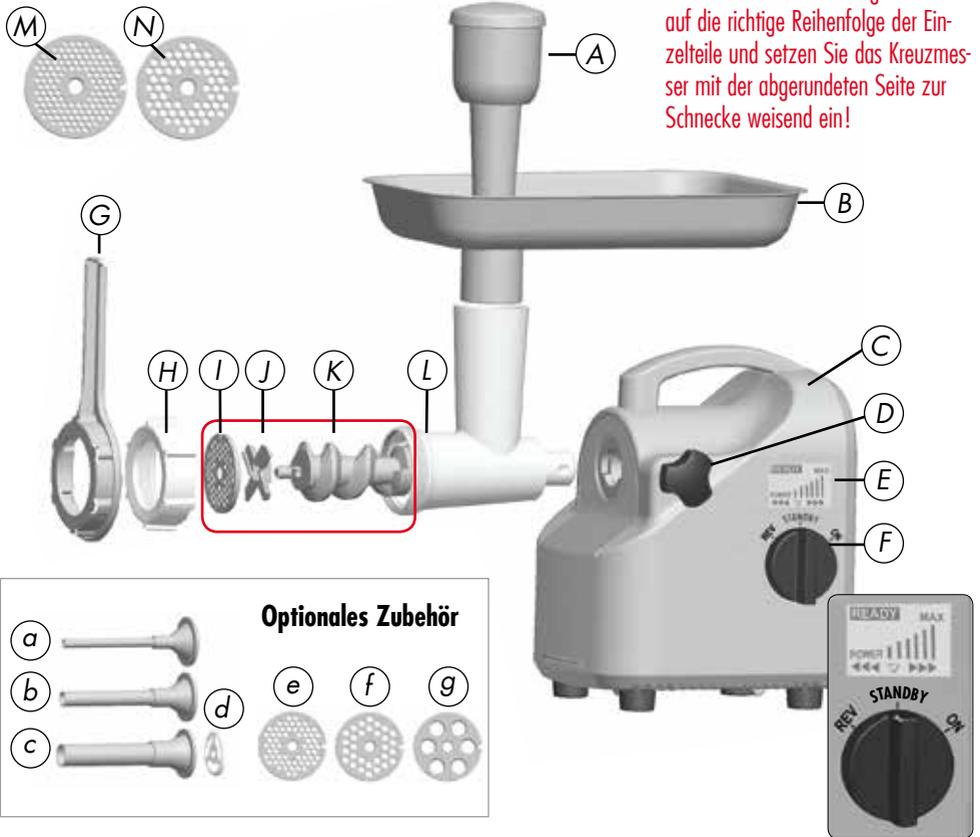
Achten Sie bei der Montage immer auf die richtige Reihenfolge der Einzelteile und setzen Sie das Kreuzmesser mit der abgerundeten Seite zur Schnecke weisend ein!
