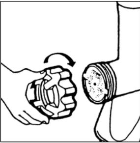
5. Schrauben Sie den Verschlussring vorn am Schneckengehäuse im Uhrzeigersinn an und ziehen Sie den Verschlussring im Uhrzeigersinn mit der Hand fest.
