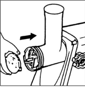
4. Legen Sie anschließend die gewünschte Lochscheibe vor dem Kreuzmesser ein. Drehen Sie die Lochscheibe dabei, bis die Aussparung in der Scheibe über den Führungzapfen im Schneckengehäuse gleitet.
