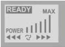
4. Das Display erleuchtet und Sie sehen auf dem Display zunächst für 30 Sekunden die Anzeige ›Ready‹ blinken sowie die Anzeige ›Power‹, ›Max‹, 6 unterschiedliche hohe Balken, 3 Pfeile nach links weisend, ein rotations Symbol sowie 3 Pfeile nach rechts weisend. Nach 30 Sekunden zeigt das Display nur noch die Anzeige ›Ready‹.
